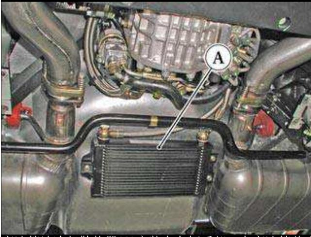
变速箱油冷却散热器(A)安装在车辆后部，在变速箱总成后面。
